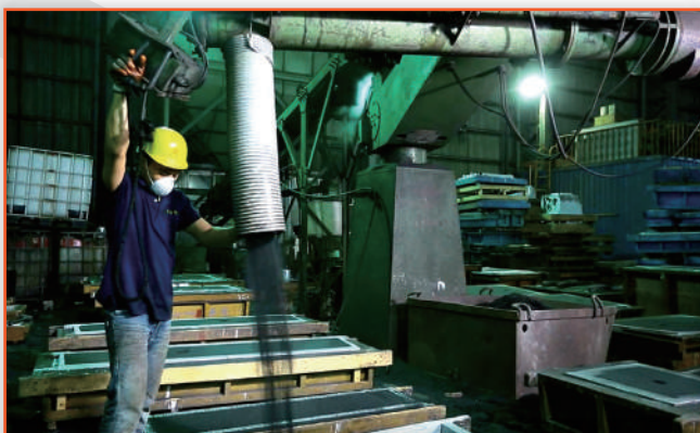
1 | サンドミキサー ( 10T/H ) x 6基 Furan No-bake Molding Lines (10 ton/h) x 6 sets
